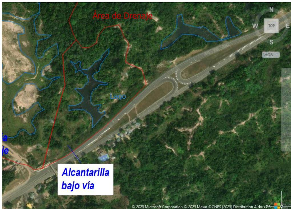
**Figura 27.** Área de drenaje hacia lago el el costado oriental de la entrada.
