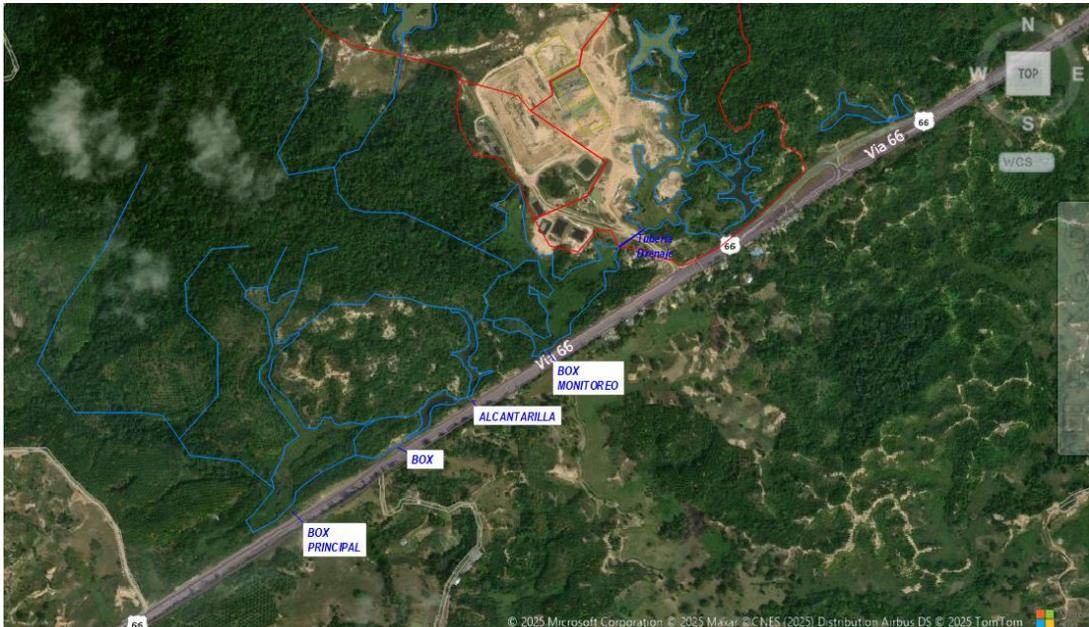
**Figura 40.** Ubicación alcantarillas bajo vía en el sector occidental
